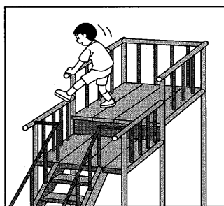
(危険な落下防止柵の例)
