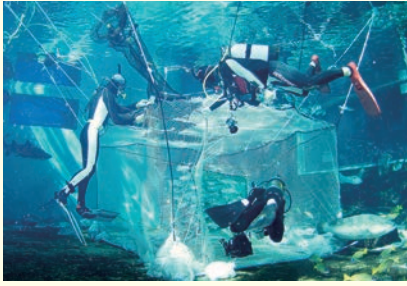
写真4 ↑ 大水槽に設置した実験用のモデル網
