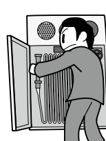
③ 消火栓の扉内に、ホースとノズルが収納されている。ホースをのばす。
