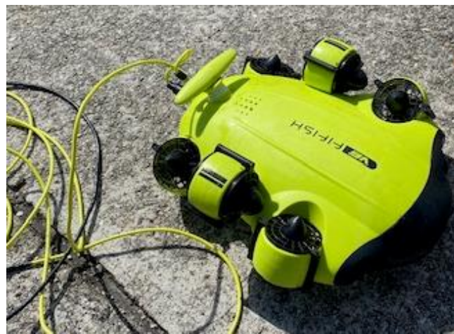
●水中モビリティ 海底に設置したLEDセンサの光信号を撮影する
