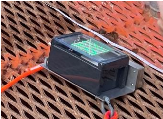
●LEDセンサ 表面のLEDで測定値を光信号として発する
