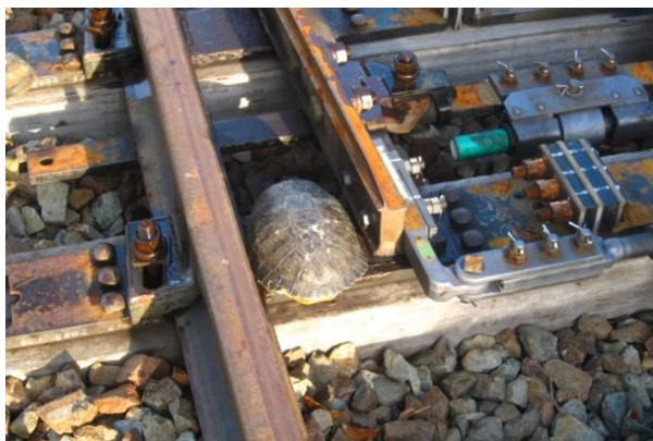
図5. カメがポイント部に介在した状況
